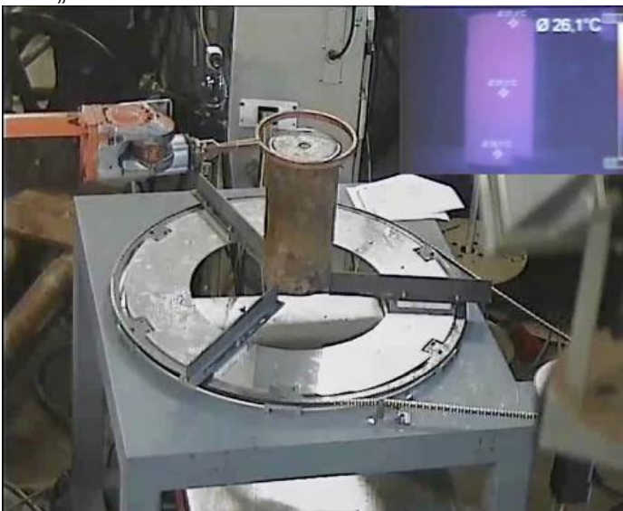
Abbildung 2: prototypische Induktionsanlage zum Herauslösen des Sprengstoffes
