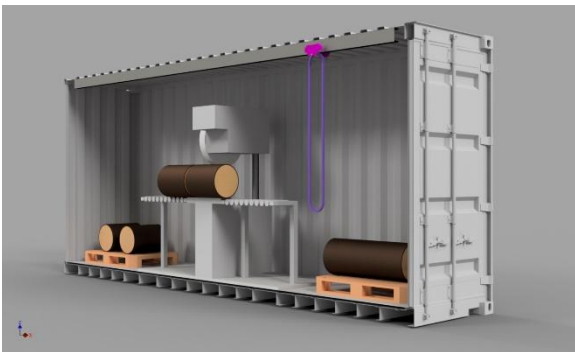
Abbildung 1: CAD Modell der mobilen Zerlegeeinrichtung
