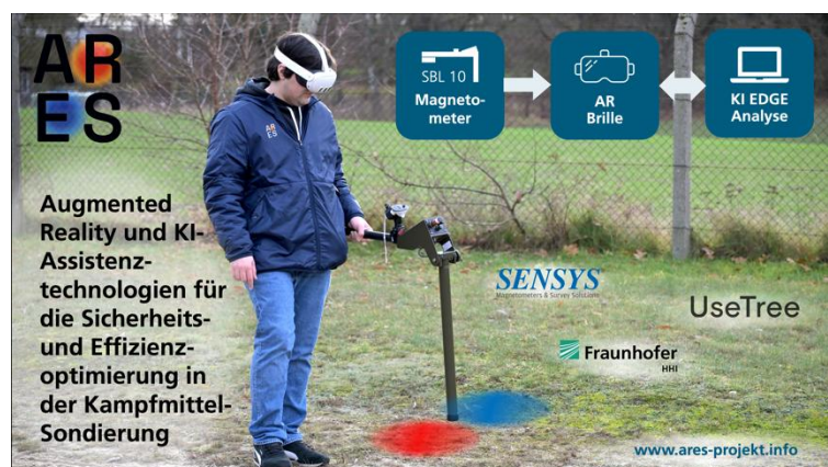
Abbildung 4 ARES-Gesamtsystem im Feldeinsatz. Das SBL 10 ist als Magnetometer mit einer AR-Brille des Projektpartners (SENSYS GmbH) verbunden. Die Messdaten werden live in der Brille angezeigt und zur weiteren Verarbeitung im Messfeld auf einen Rechner mit höherer Rechenleistung übertragen, um die KI-Verarbeitung (EDGE Computing) durchzuführen. Die Ergebnisse werden zurück in die AR-Brille übertragen, um die magnetische Karte des Sondierungsgebiets und die Verdachtspunkte direkt im Feld anzuzeigen.
