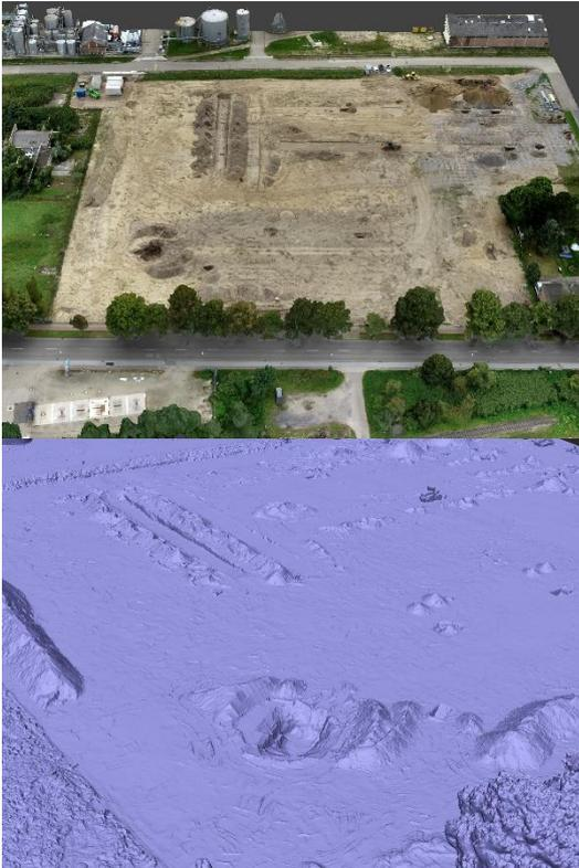
*Abb. 3: Bestens für die Flächen-dokumentation geeignet. Oben: Drohnenvotos ergeben ein detailsreiches, terrestrisches Geländemodell. Unten: Im Detail sieht man die Aufgrabung eines Bombentrichters. Auch Volumina-messungen sind ohne Probleme möglich.*
