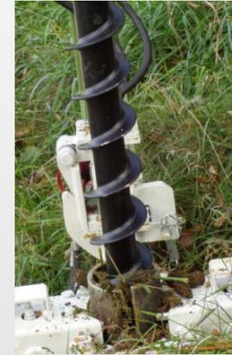
Die Vorteile beim Antrieb mit dem Lafettenbohrgerät : Richtungstreue beim Ansetzen vor allem bei Aufbrucharbeiten und bei Schrägbohrungen. Hier können Einrichtungsgenauigkeiten von 3° Grad erzielt werden. Ein maschineller Vorschub erzeugt nur geringe Ausknickbewegungen im Schneckenstrang.
